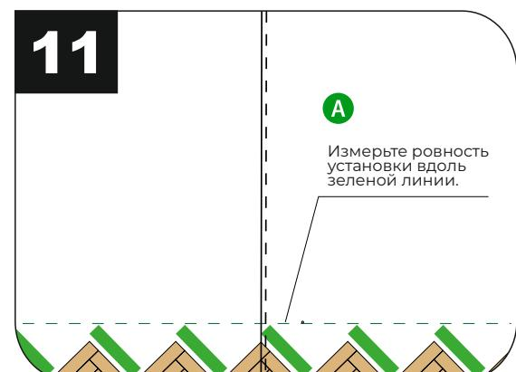
Отрежьте левый край так, чтобы он соответствовал размеру помещения с учетом зазора для расширения 8 мм.
