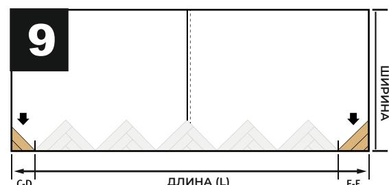
**7.6.2** Установите А-образные плашки, как показано на рисунке. Тщательно проверьте стык между плашкой А и треугольником. Не должно быть никаких выступающих краёв и зазоров!
