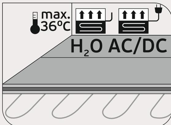
**3.3 Важно!** Температура поверхности пола с покрытием должна соответствовать требованиям СП 60.13330 и не превышать +36°C на поверхности покрытия. При укладке способом приклеивания к основанию **ОБЯЗАТЕЛЬНО** учитывать рекомендации производителя клея к температуре нагревания поверхности пола.
